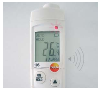
Akustický a optický alarm (svítí LED dioda)
