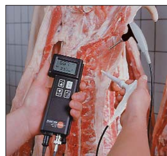
Kontrola pH a teploty jádra masa pomocí robustní vpichovací sondy se speciální rukojetí (patentováno)
