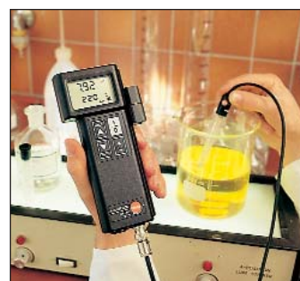
Přesné pH měření ve vodných mediích jako kyseliny nebo louhy
