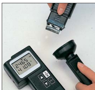
Měření frekvence kmitání
