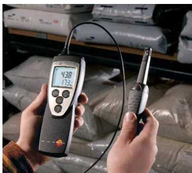
Vlhkosní sonda na rukojeti propojená kabelem při kontrole ovzduší ve skladu
