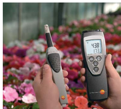
Vlhkosní sonda na rádiové rukojeti při kontrole nastavení klimatizace
