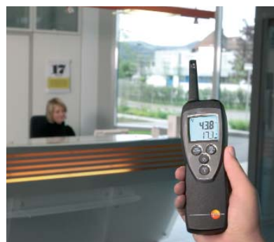
testo 625 s vlhkosní sondou při kontrole ovzduší v místnosti
