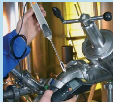
Připojení externích teplotních sond (testo 830-T2/T3)
