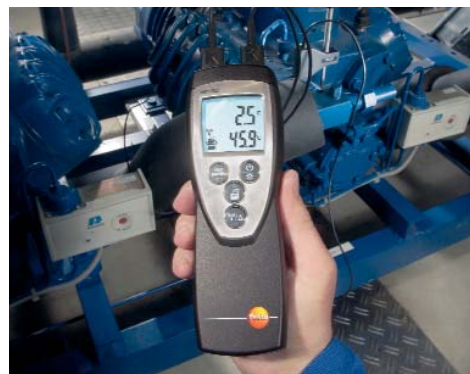
Současné měření přehřátí a podchlazení na chladicím zařízení pomocí přístroje testo 922
