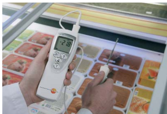
Měření teploty vzduchu v chladicích vitrínách a mrazicích pultech
