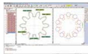
Příklad porovnávání kontury ozubeného kola a analýza průměru přes zuby.
