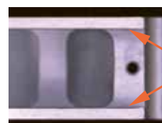
Měření hran stupňovitého obrobku (režim s vysokým rozlišením)
