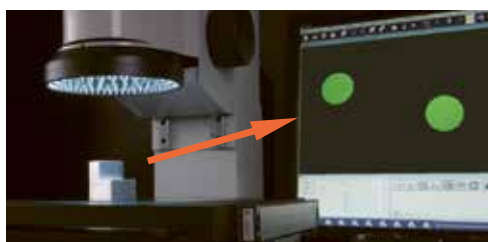
Zaostření obrobku, který je výše na obrázku, není zapotřebí.
